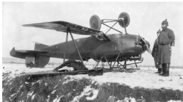
Die Albatros D.III von Manfred von Richthofen am 24. Januar 1917, unmittelbar nach seinem 18. Luftsieg, bei dem ihm der untere Flügel brach. Er überlebte unverletzt. Die Maschine war zu diesem Zeitpunkt sicher leuchtend rot lackiert. Quelle: Bruno Schmaling
