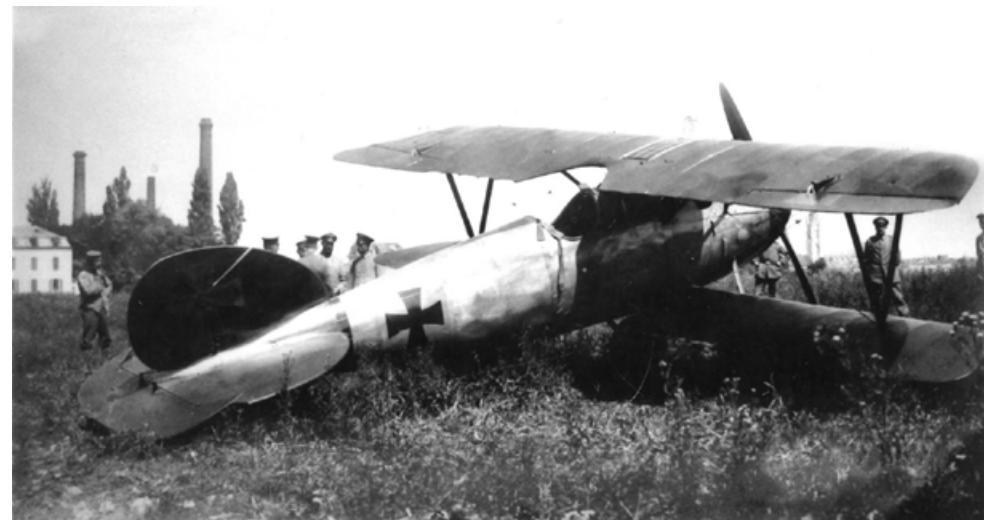
Manfred von Richthofens Albatros D.V nach seiner Notlandung am 06.07.1917. Bei diesem Einsatz wurde er schwer verwundet. In dieser Aufnahme sind das runde Ruder und die Form der Flügelspitzen deutlich erkennbar. Sein Flugzeug war nicht mit der Kopfstütze ausgerüstet. Der Rumpf war nicht mehr komplett rot lackiert. Die Oberste Heeresleitung hat befohlen, die Farbe zu entfernen.
